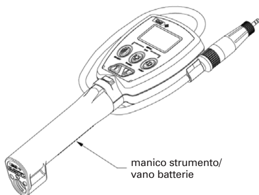
Fig. 13.10 Collocazione batteria GT series
