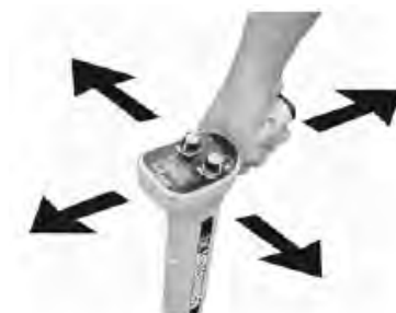
Figura 5. Tracciare a “croce” permette localizzazioni precise
